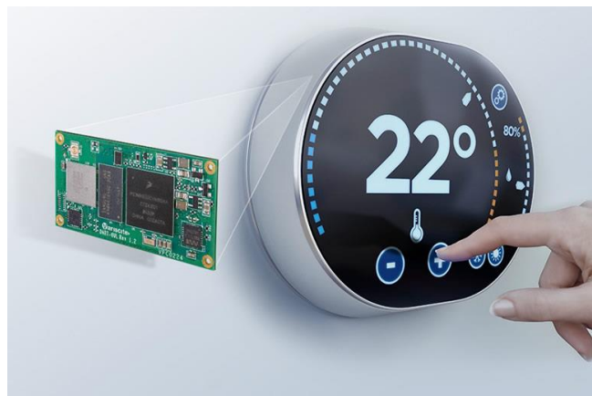
Abbildung 45: Thermostatsteuerung realisiert durch eingebettete Systeme (Quelle: Variscite, https://www.variscite.de/ , abgerufen am 24.09.2023)
