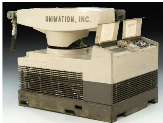
Abbildung 18: Der erste industrielle Roboter „Unimate“ (Quelle: IEEE Spectrum, https://spectrum.ieee.org/unimation-robot , abgerufen am 24.09.2023)
