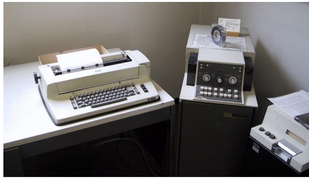
Abbildung 20: IBMs erstes Schreibsystem MT/ST beziehungsweise MB 72 (Quelle: Heise, https://www.heise.de/hintergrund/Der-Mensch-denkt-die-Maschine-arbeitet-302172.html , abgerufen am 24.09.2023)
